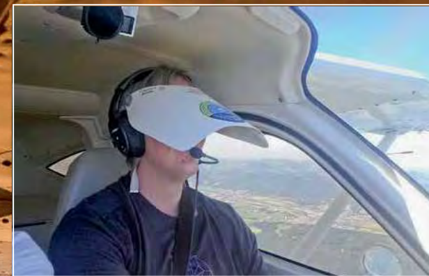
Mit dieser Haube wird der Blick nach draussen geraubt und somit der Einflug in eine Wolke simuliert. Der Pilot muss sich fortan nur noch anhand der Instrumente orientieren.
